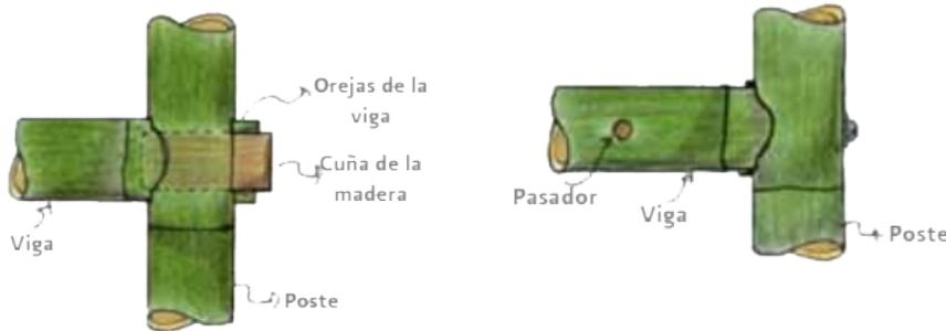
Figura 18. – Unión de un elemento interno.
