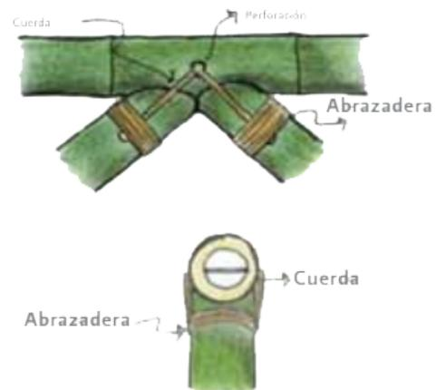
Figura 12. – Conexión de correa de dos abrazaderas y tres perforaciones.
